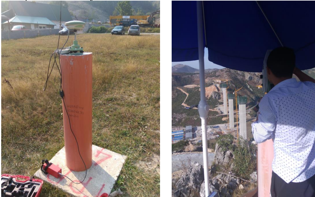
Slika 4. Izgled stuba geodetske mreže za posebne namjene
